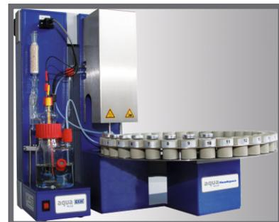
AQUA 40.00 с модулем для парофазного дозирования проб
